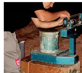
Foto 16 - Aferição da massa específica do concreto
