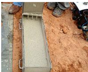
Foto 17 - Medição da fluidez do concreto
