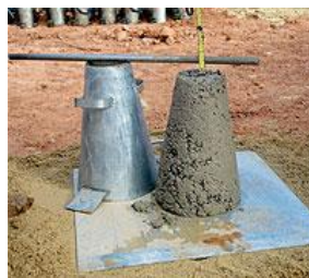
Foto 15 - Verificação do slump do concreto
